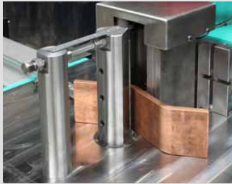
Prisma mit integriertem Messsystem für automatisches Nachbiegen.
