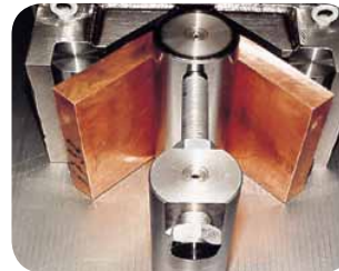
Biegen von Dicken bis 30 mm Bending thickness up to 30 mm
