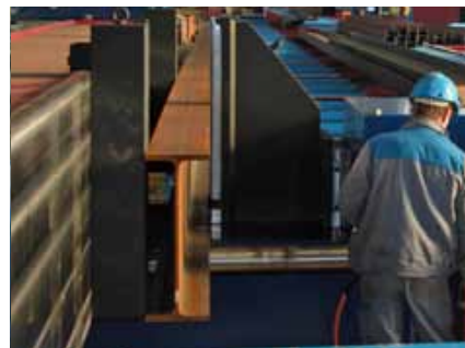
277 Richtpresse in Trägerfertigung integriert Cambering machine integrated in beam line
