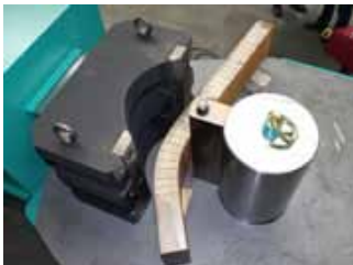
94 250x100 mm Querschnitt biegen 250x100 mm section bending
