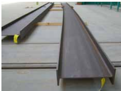
276 Biegen, Richten, Vorspannen (Überhöhen) Bending, straightening, cambering
