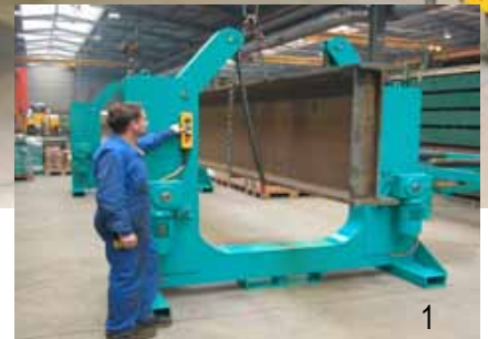
301 Träger absenken Lower the beam
