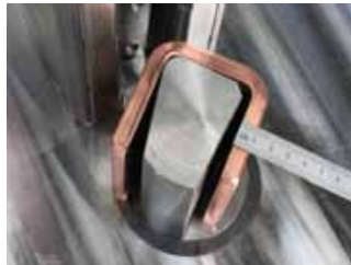
71 Enge Biegungen m. Sonderstempel Narrow section punch
