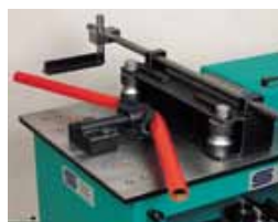
322 Rohre biegen Pipe bending
