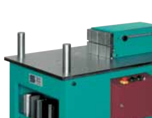
102 Richten mit Richtbolzen (420 HE) Straighten with straighteing pins
