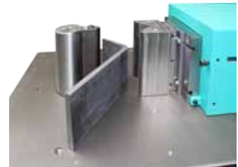
103 Biegen mit Biegeprisma Bending with V- Blocks
