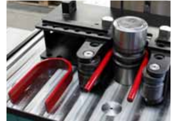
89 Horizontal biegen bis 180° Horizontal bending up to 180°
