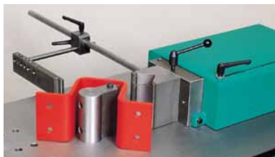
184 Zweiachsiger einstellbarer Anschlag "M600" mit Skala Two-axis adjustable back gauge "M600" with scale
